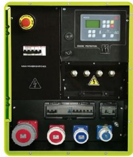
Coffret de contrôle automatique pour démarrage automatique du groupe électrogène. Il est équipé d'une unité de contrôle AC03 avec microprocesseur pour commande, contrôle, mesure et protection du groupe électrogène. Le coffret intègre aussi le disjoncteur de puissance qui assure la protection du groupe électrogène et des équipements qu'il alimente.
