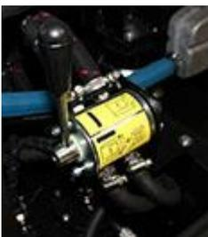
Vanne carburant trois voies pour le raccordement rapide à un réservoir externe en cas de chantier de longue durée.
