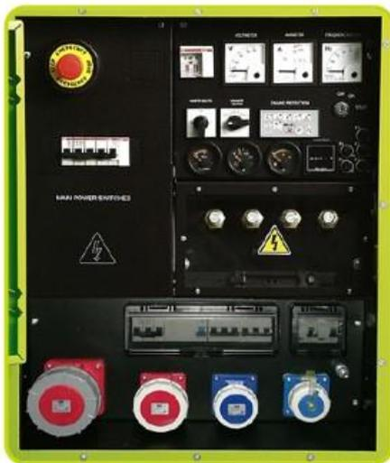
Coffret de contrôle et de commande manuel du groupe. Il est équipé d'une unité de commande et de contrôle MC-01. Il sert pour une utilisation de production ou sur les chantiers. Le coffret intègre aussi le disjoncteur de puissance qui assure la protection du groupe électrogène et des équipements qu'il alimente.
